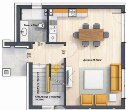
РАЗПРЕДЕЛЕНИЕ партер къща № 1 М1:100 / 63.41m²/
