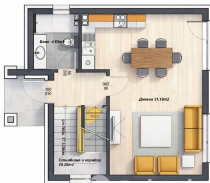
РАЗПРЕДЕЛЕНИЕ партер къща № 1 М1:100 / 63.41m²/
